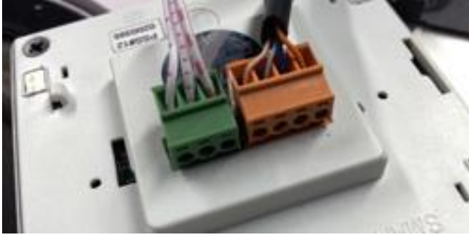
الشكل رقم 4: طريقة الربط مع شبكة S-BUS اللون البرتقالي ، و الربط باستقبال الاشارة اللون الاخضر
