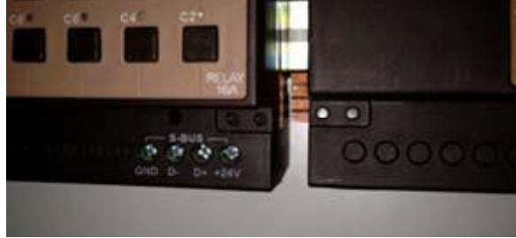
الشكل 4: توضيح طريقة الربط عن طريق قطار المتتالية
