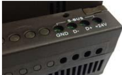
الشكل 3: مخارج الربط التقليدي لشبكة S-BUS
