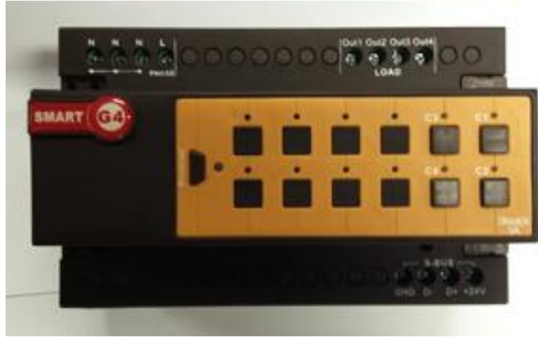
الشكل 11: مخفت اناارة باربع قنوات قدرة 3 امبير لكل قناة
