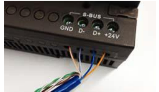
الشكل 9: ربط الشبكة بالطريقة التقليدية
