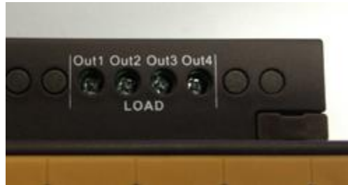
الشكل 13: مخارج تغذية الوحدات من المخفت
