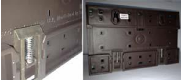
الشكل 5: توضيح مكان التثبيت بجسر اللوحة
