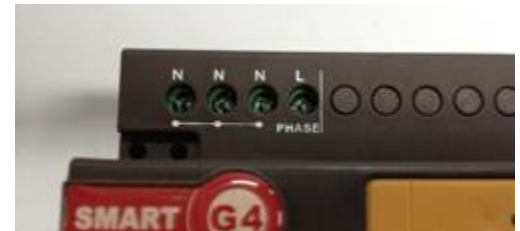
الشكل 12: مداخل تغذية الطاقة للمخفت
