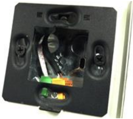
الشكل رقم 2: الحامل الحديدي الخاص باللوحة الرقمية المتغيرة، يتم تزويده مع العلوية، و يشبث بعلب الحائط 55
