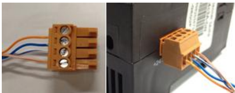
תמונה 10-חיבור כבל רשת דרך מחבר מהיר
