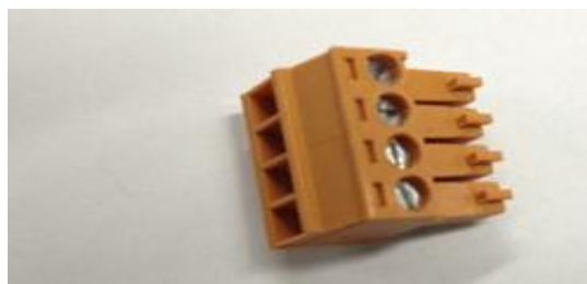
תמונה 6-מחבר כתום לחיבור הרשת
