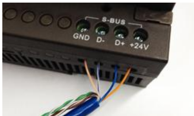
תמונה 9-חיבור כבל רשת לפס חיבורים בבקר
